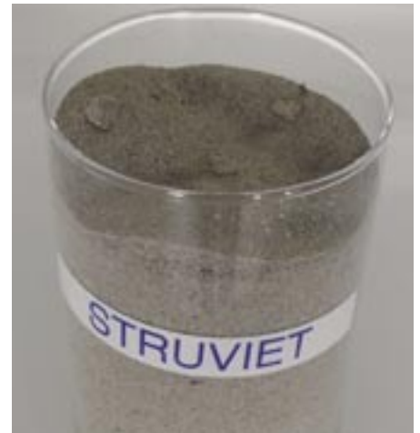
Les microscopiques cristaux de phosphate de magnésium-ammonium qui sortent du réacteur sont appelés struvite.
