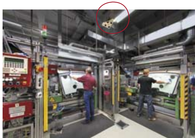
En haut: le nouveau système permet la surveillance de plusieurs espaces de protection indépendants les uns des autres. En bas: les espaces de protection et d'alerte peuvent être résumés en aménagements spatiaux complexes.
