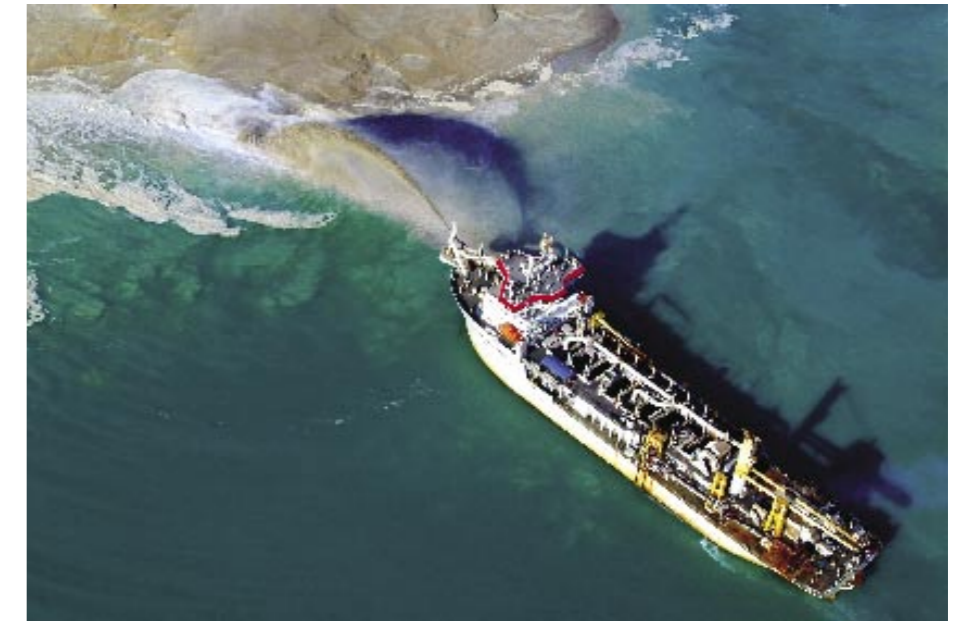
Le dragueur Jan De Nul Group au travail sur l'un des projets de remblayage les plus prestigieux du monde: Palm Island dans les Émirats arabes unis (photo: Jan De Nul).
