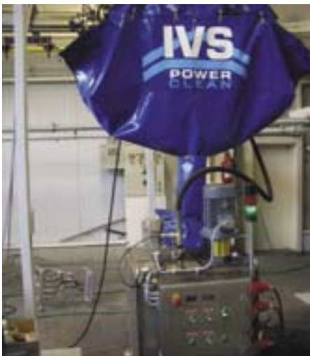
Le Powerclean de la société allemande IVS. Cette installation nettoie sur place les chaînes de transport des entreprises de peinture. (photo: MAC Industrial)
