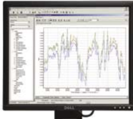
Laborelec enregistre en permanence des paramètres de qualité de la tension ainsi que des événements tels que des coupures et des chutes de tension.
