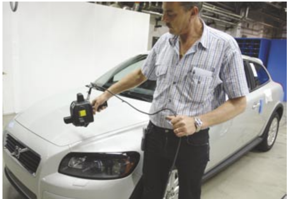
Un autre développement en coopération a été réalisé sur le scanner laser manuel portable K-Scan pour les travaux de contrôle mobile.
