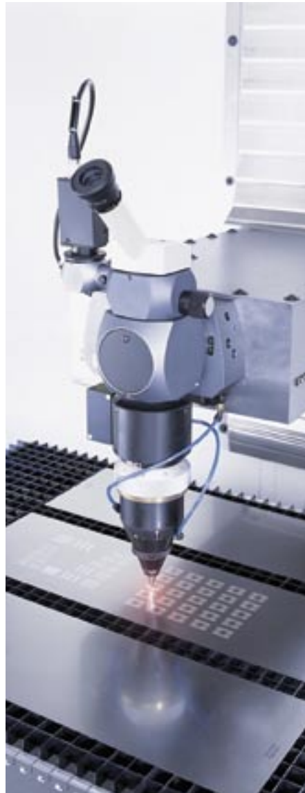
Un autre exemple d'une configuration mécatronique: une machine à coupe laser. de Gildemeister.
