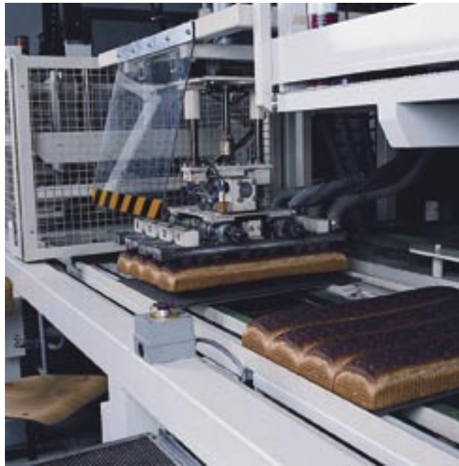
Un système, conçu par la société japonaise Omron: une table de transfert.
