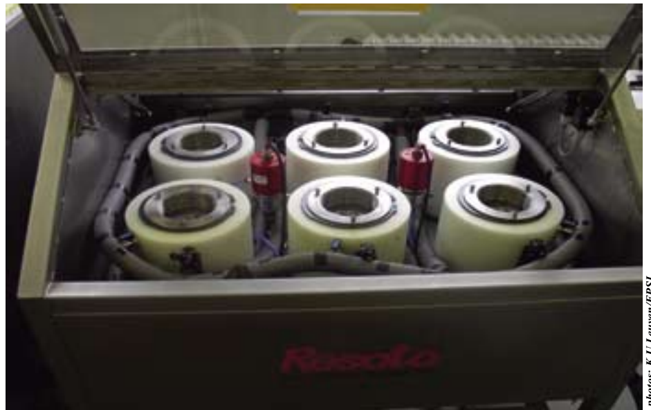
Le système de multi autoclave sous haute pression utilisé par le Centre des techniques alimentaires et microbiennes atteint une pression de travail jusqu'à 1.000 Mpa (10.000 bar) et une température de travail de -30 à +90°C.
