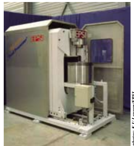
Notre pays compte un des rares constructeurs d'autoclaves à haute pression: Engineered Pressure Systems International. Il a construit ce high pressure food processor à des fins de R&D au BAFF en Allemagne.
