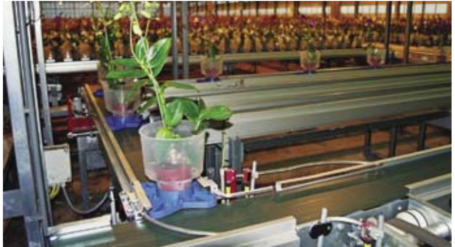
Les pots d'orchidée vides de Pannekoek accueillent un transpondeur RFID Gen2. Celui-ci permet d'assurer la traçabilité individuelle, l'enregistrement des données et les tâches de tri.
