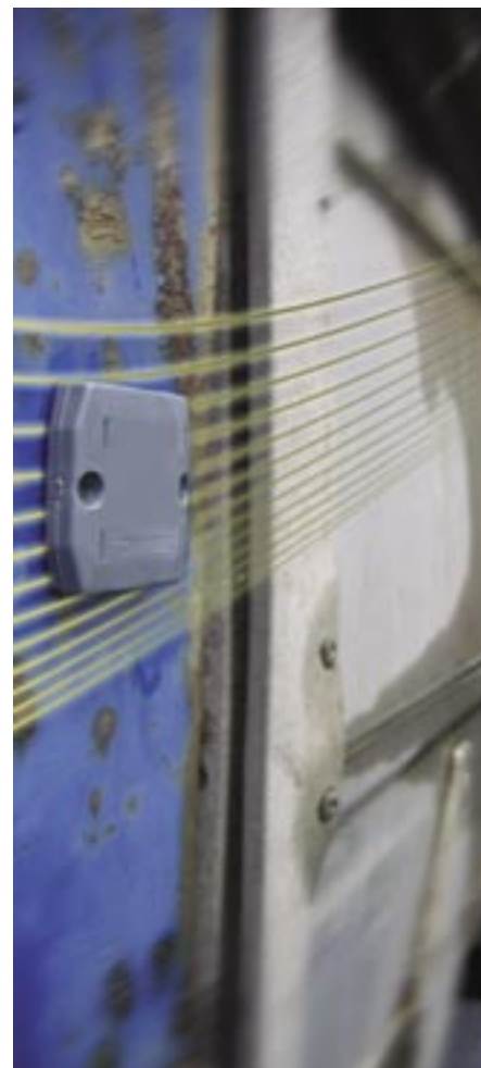
Un transpondeur spécialement conçu pour être fixé sur des surfaces métalliques. Conforme au standard EPC Class 1 Gen 2. (photo: Confidex).
