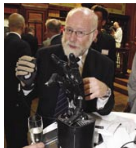
Une main électromécanique développée pour la défense anglaise. Elle dispose de 24 degrés de liberté. Elle est commandée soit à l'aide d'un gant numérique, soit plus directement via un logiciel.
