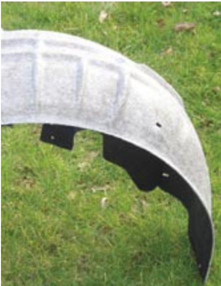
Des bouteilles PET peuvent être utilisés comme matière première pour la fabrication de fibres de tapis de voitures, plages arrière, revêtement de compartiment à bagages, etc.
