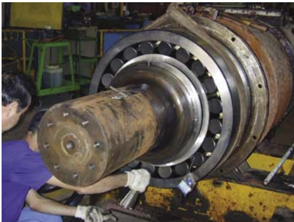
Montage d'un palier Sensormount. Glisser un palier sur le grand axe a toujours été un travail très pénible qui semble fort facilité avec un palier Sensormount.
