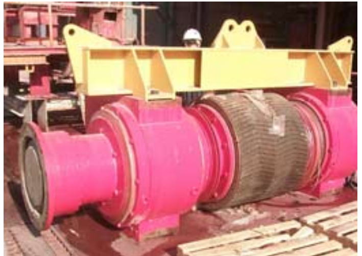
Le compacteur après « overhauling », avec les paliers Sensormount.
