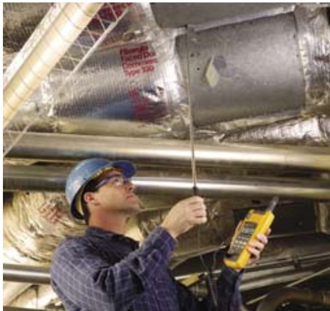
L'AirMeter Fluke 975 est équipé d'une sonde de vitesse, qui utilise un anémomètre thermique pour mesurer la vitesse de l'air.
