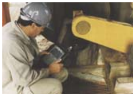
La surveillance de l'état des installations, ou condition monitoring, consiste à mesurer régulièrement plusieurs paramètres sur la machine : température, niveau de l'huile, vitesse, fréquence des roulements, alignement des axes, bruit, vibrations et bien d'autres.
