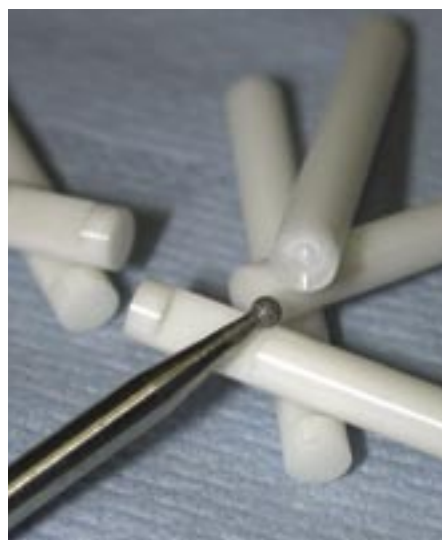
Les matériaux céramiques sont utilisés comme goujon pour le soudage par friction-malaxage, comme insert dans les matrices de presse, dans les guides de fils, les outils tranchants, etc.
