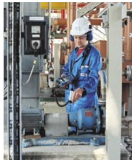
Contrôle ultrasonore des cavitations de pompe avec la sonde de contact.
