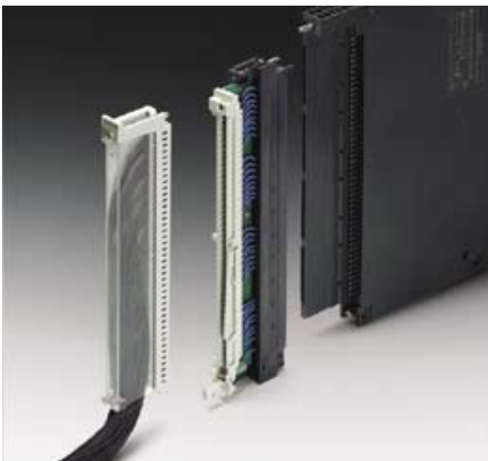
Grâce au Varioface, le câblage de l'ancien S5 pouvait être branché directement dans le nouveau S7.
