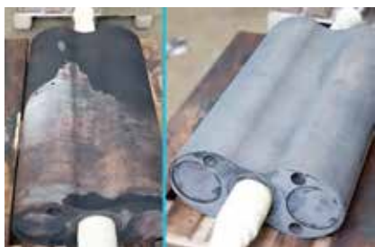
Voor en na laserreiniging van een vacuümpomp. (Foto : Netalux)
