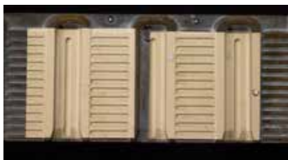
Laserreiniging van een matrijs in de farmaceutische industrie. (Foto : Netalux)
