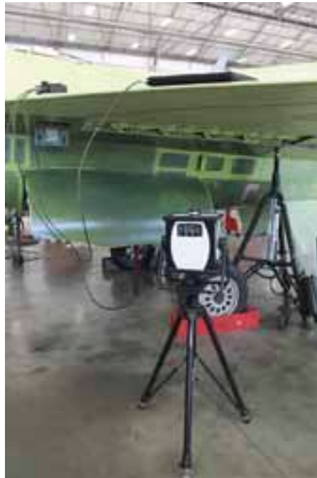
Foto boven en onder: X-ray inspectie van een vleugel van een F16.
