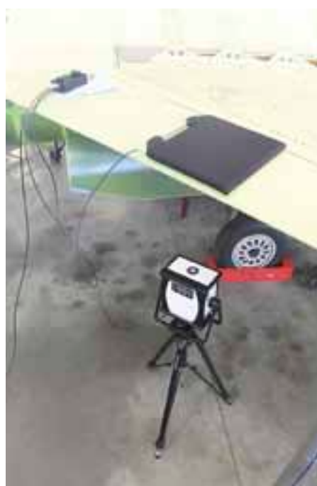
Foto boven en onder: X-ray inspectie van een vleugel van een F16.
